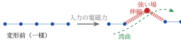
Figure 4 入力電磁力による変形。強い場のノード周辺で辺が伸び（ばね＝伸縮）、ローレンツ力で経路が曲がる（湾曲）。
